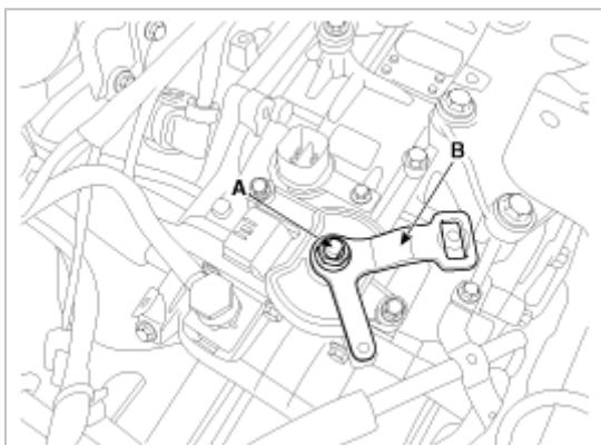
安装时，用05mm(0.1969in.)工具连接手动控制杆和档位开关。然后拧紧档位总成固定螺栓。
