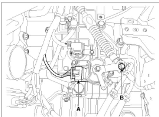
6. 拧下螺母(A)后，拆卸手动控制杆(B)和垫圈。
